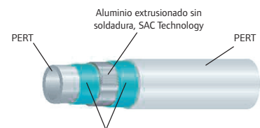
Adhesivo para la perfecta unión entre las capas de PERT y la de Aluminio y evitar la desfoliación. El color azul del adhesivo es para diferenciarlo de las tuberías multicapas con soldadura.
