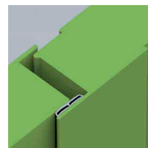
giunto centrale porta a due ante
